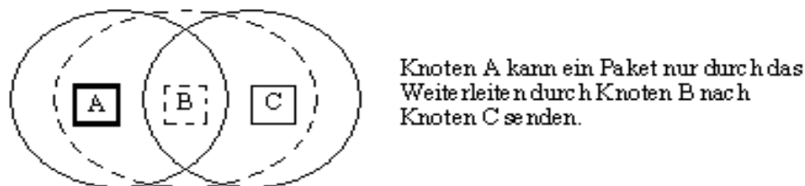
Abbildung 2: Routing in Ad-hoc-Netzen
